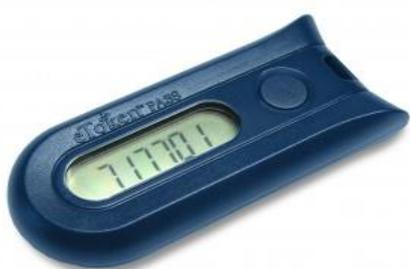
Используемый алгоритм для формирования одноразового пароля – 3-DES (Triple Data Encryption Standard). В ОТР-токен встроены часы реального времени. Длина одноразового пароля при стандартной инициализации – 6 цифр. Окно валидности (время действия пароля) – 21 минута).
